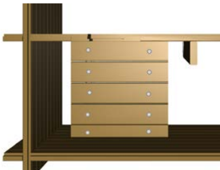
Abbildung 15 – Montage des Box-Bodens
