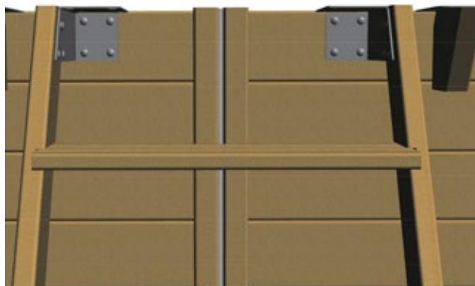
Abbildung 16 – Anbringen der Außentreppe am Becken
