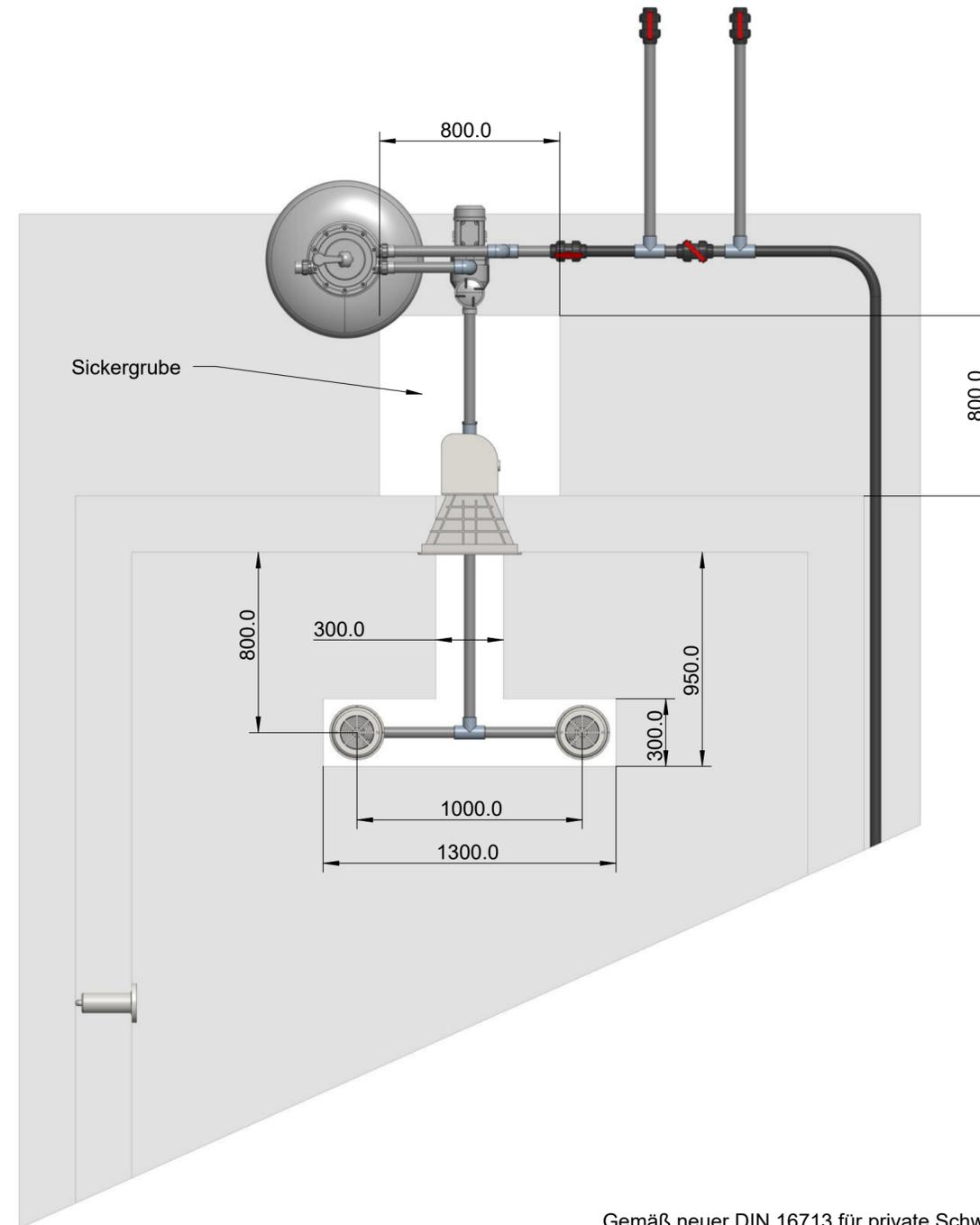
Gemäß neuer DIN 16713 für private Schwimmbäder müssen zur Unfallverhütung bei Verwendung von Bodenabläufen auf der Saugseite der Pumpe 2 Bodenabläufe im Abstand von mindestens 1 Metern installiert werden.
